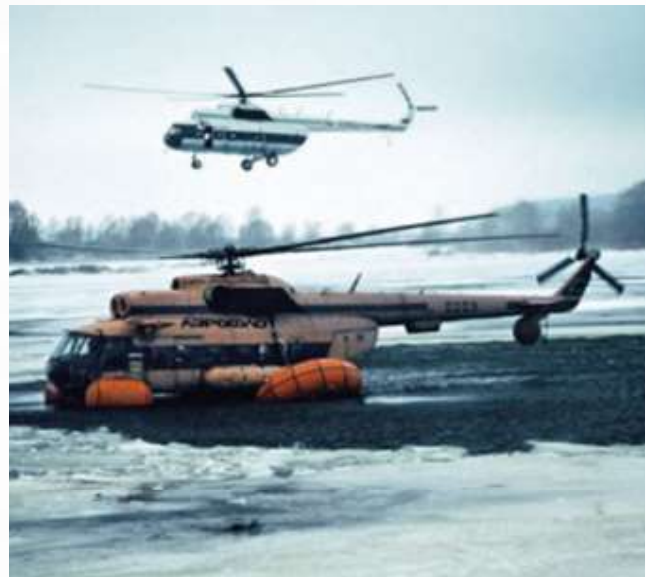
Mi-17 de Aeroflot posado sobre el agua con los flotadores desplegados. Fuente: https://spm-aero.ru/i/aerazurhfloatmi8_onwater.png
