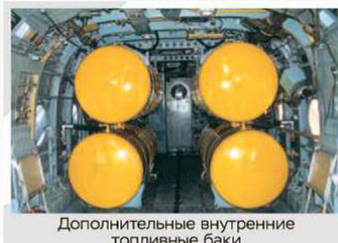
04 Depósitos internos de 915 litros en la cabina de carga. Nótese los asientos plegables delante de los depósitos de combustible. Russian Helicopters (s/f) Voennno-Transportie vertolet Mi-17V-5. Fuente: https://www.rhc.aero/uploads/Documents/Mu-17B-5.pdf
